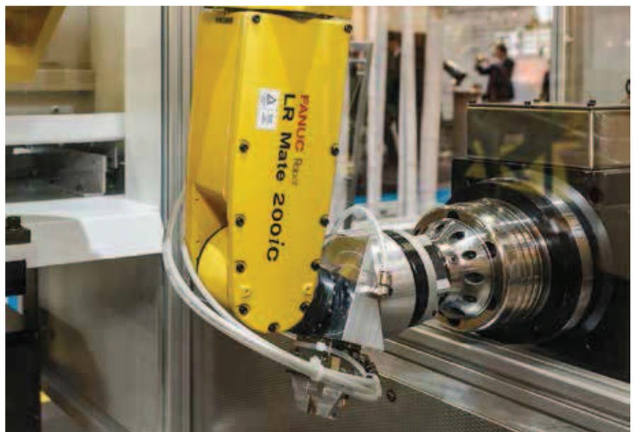
**Spannkopf von Hainbuch:** Leicht lässt sich dieser mit einem Roboter wechseln.
