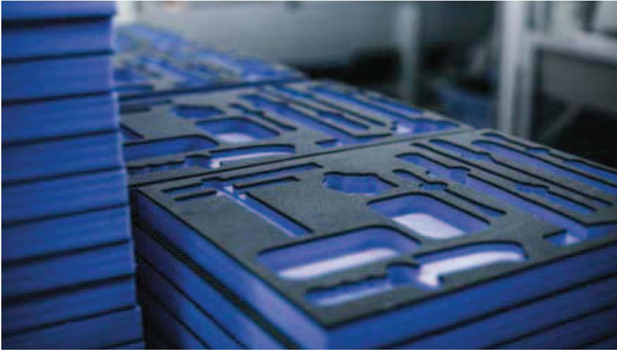
**Gefräste Schaumstoffeinlagen von Wetropa:** Passgenau werden sie für verschiedenste Produkte angefertigt.
